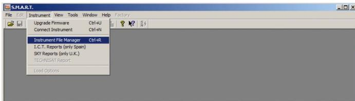
Dieser verbindet sich mit dem CATVmeter und zeigt die gefundenen Verzeichnisse des Gerätes an. Darin befinden sich die vom Gerät gespeicherten PLAN- und LOG-Files.
