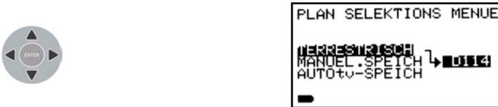
Unter dem Menüpunkt **TERRESTRISCH** sind zusätzlich 2 Speicherpläne abgelegt, die dem Raster der meisten deutschen Kabelnetze entsprechen – **D113** und **D114**. Damit werden digitale Kanäle im 8-MHz-Raster unterhalb 300 MHz erkannt. Zuerst muss also der für den jeweiligen Kabelnetzbetreiber zutreffende Plan gewählt werden. Die Auswahl ist unter **CONFIG / TV KONFIG.&RASTER / LAND** vorzunehmen!
